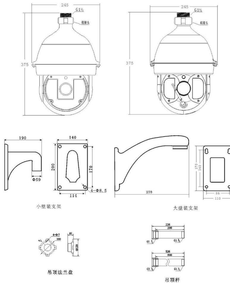
注：图中所示尺寸单位为mm，G1½为圆柱管螺纹连接
